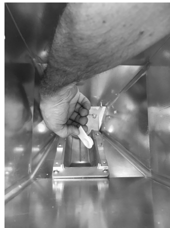
Fig. 31 - Remoção do rolamento
