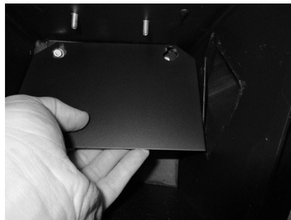
Fig. 38 - Remoção do desviador de fumos
