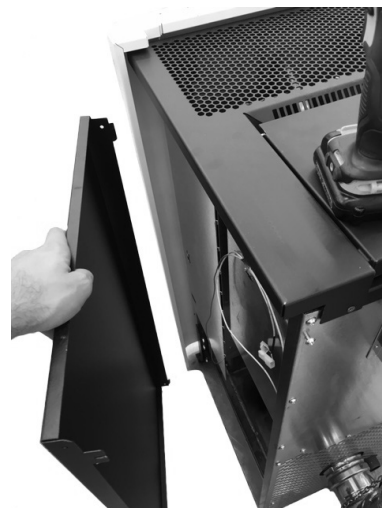
Fig. 36 - Extracción de los laterales
