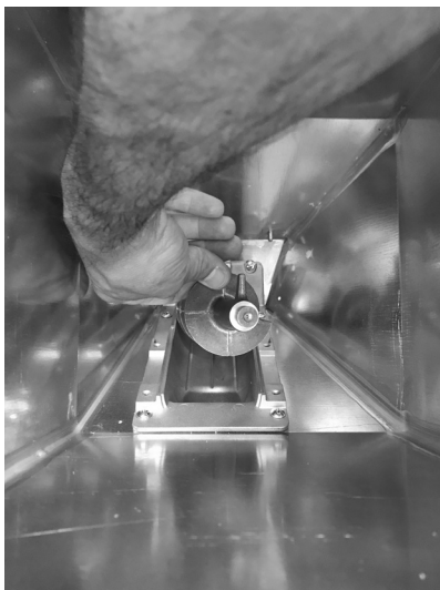
Fig. 47 - Extracción de la espiral
