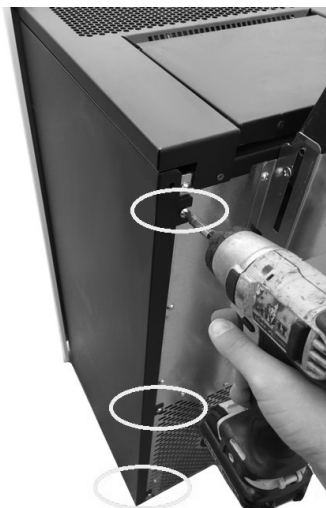
Fig. 34 - Afloje los tornillos
