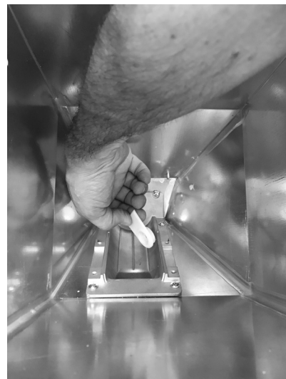
Fig. 48 - Extracción del cojinete
