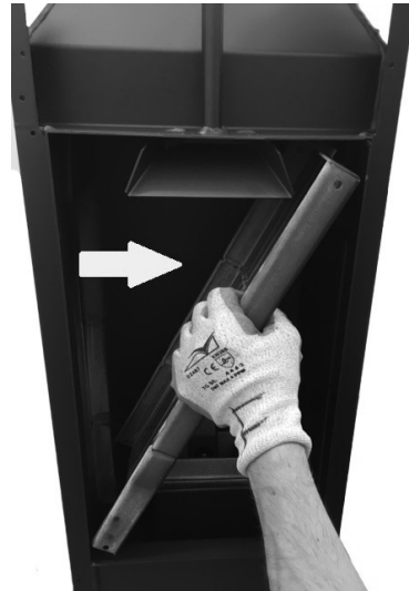
Fig. 42 - Entfernen der linken Rauchführung
