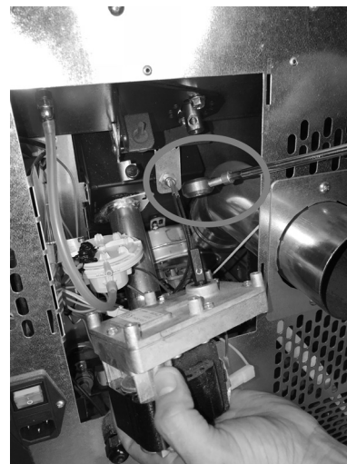
Fig. 38 - Getriebemotor entfernen
