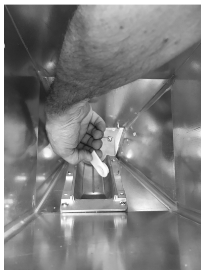
Fig. 40 - Lager entfernen
