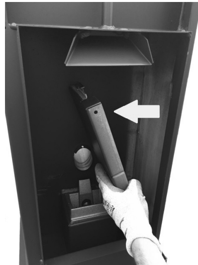
Fig. 44 - Entfernen der rechten Rauchführung
