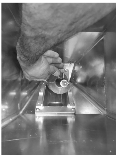
Fig. 39 - Spirale entfernen
