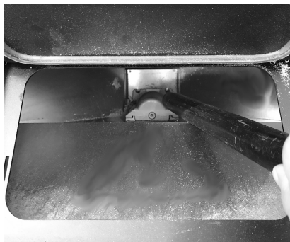
Fig. 25 - Pulizia serbatoio e coclea
