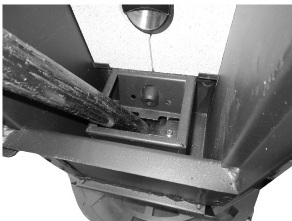
Fig. 22 - Rengøring af fyrfadsrum
