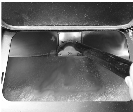
Fig. 24 - Rengøring af magasin og snegl
