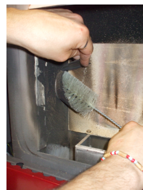
Fig. 32 - Čiščenje s ščetko
