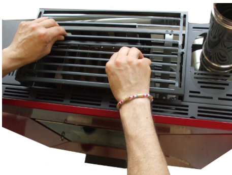
Fig. 41 - Odstranjevanje zgornje rešetke
