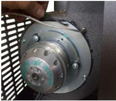
Fig. 37 - Limpeza do aspirador de fumos: fase 1
