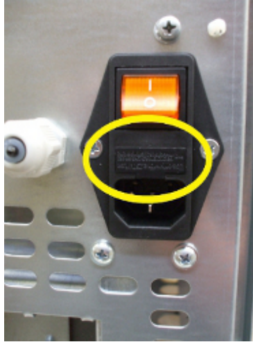
Fig. 45 - Porta com fusíveis a remover
