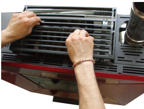
Fig. 41 - Remoção da grelha superior
