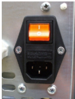
Fig. 21 - Tomada elétrica com interruptor geral
