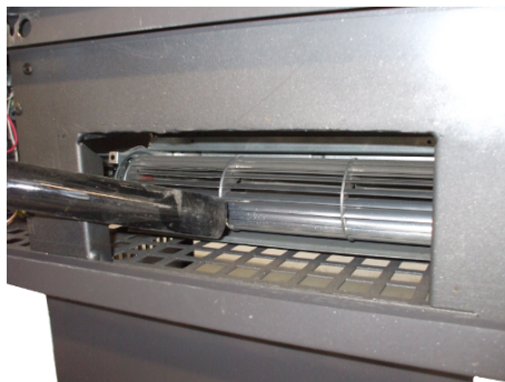
Fig. 40 - Limpeza do ventilador ambiente
