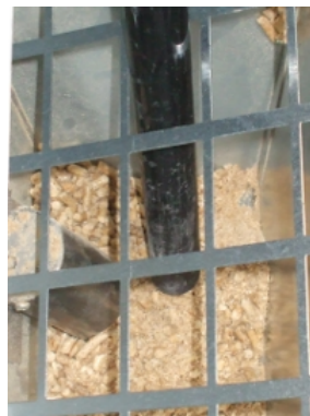
Fig. 33 - Limpeza do reservatório e da rosca sem fim
