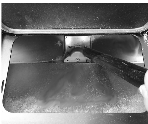
Fig. 30 - Limpeza do reservatório
