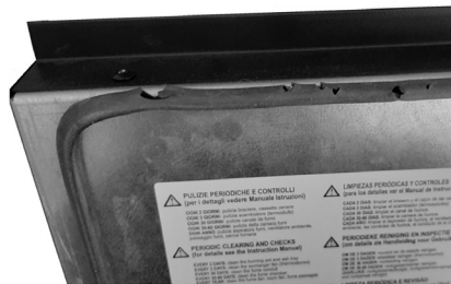
Fig. 21 - Junta deteriorada
