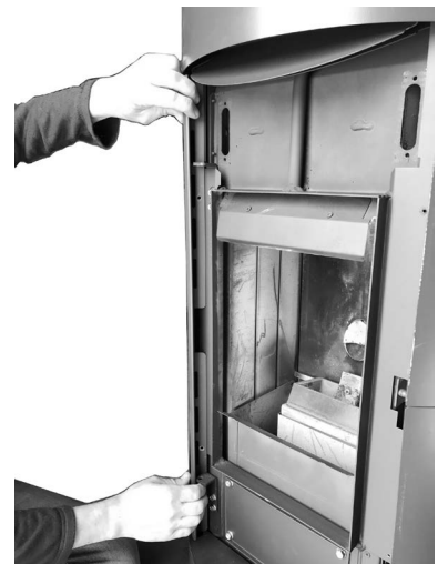
Fig. 66 - Αφαίρεση μπροστινών προφίλ (δεξιά και αριστερά).
