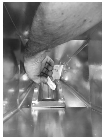
Fig. 82 - Αφαίρεση ρουλεμάν
