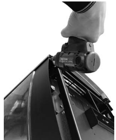
Fig. 57 - Kompansatörü sabitleyin
