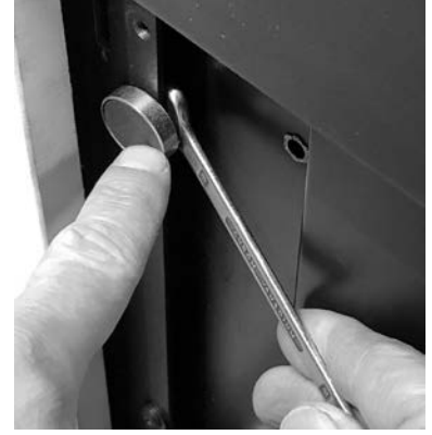
Fig. 42 - Mıknatısı ayarlayın ve anahtarla kilitleyin
