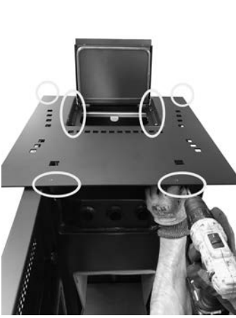
Fig. 58 - Vidaların çıkartılması
