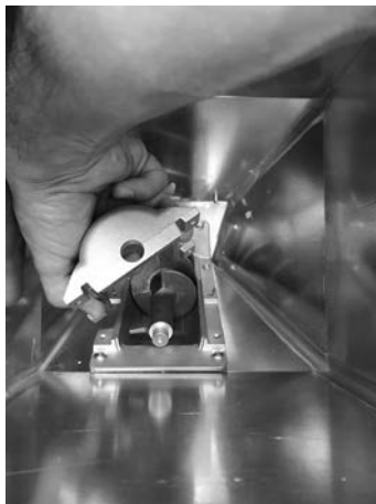
Fig. 53 - Remoção do casco
