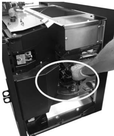
Fig. 61 - Remover os parafusos
