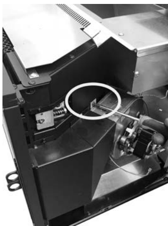
Fig. 58 - Remover o parafuso 1
