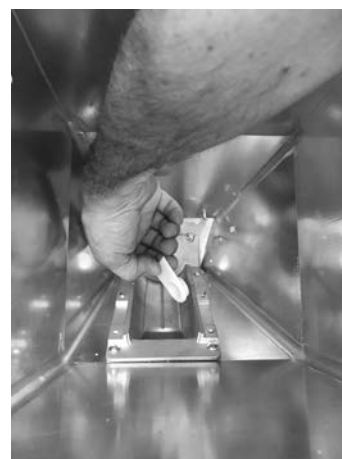
Fig. 56 - Remoção do rolamento
