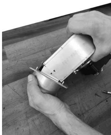
Fig. 32 - Fixar o flange + conexão no ventilador
