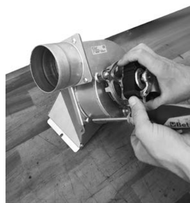
Fig. 36 - Fixar com parafusos
