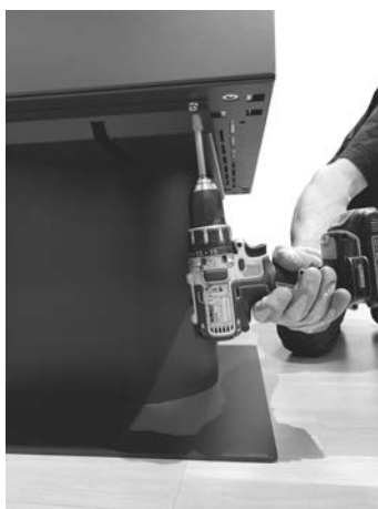
Fig. 18 - Fixação da base
