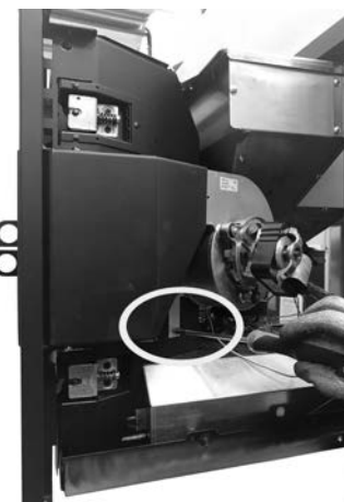
Fig. 59 - Remover o parafuso 2
