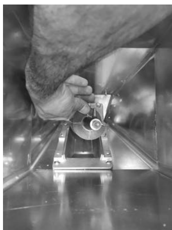
Fig. 55 - Remoção da espiral
