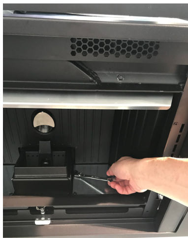
Fig. 36 - Entfernung der kleinen Böden
