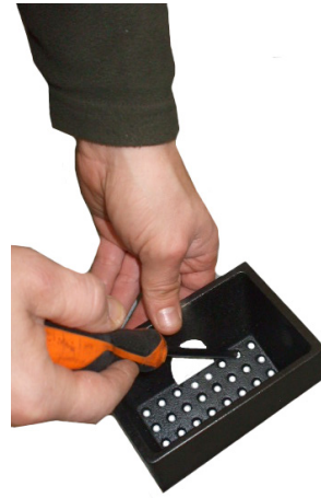
Fig. 32 - Reinigung Brennschale
