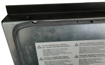
Fig. 23 - Verschlechterte Dichtung
