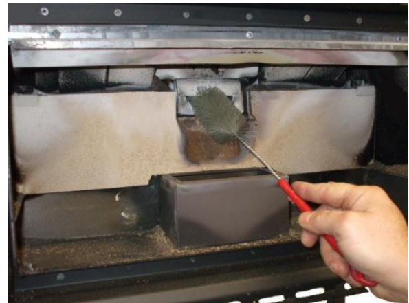
Fig. 34 - Reinigung mit Flaschenbürste
