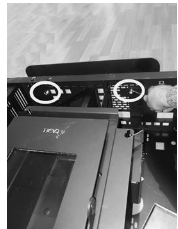
Fig. 54 - Bloquear os parafusos
