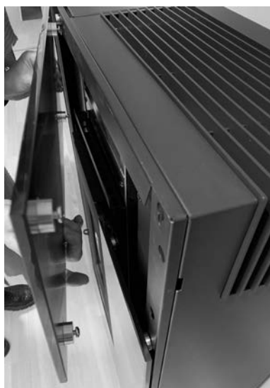
Fig. 39 - Encaixar o vidro
