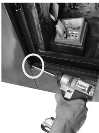
Fig. 44 - Remoção de parafusos 1
