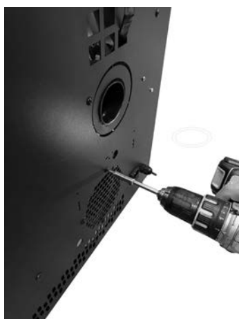
Fig. 70 - Remover os parafusos
