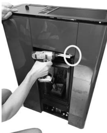
Fig. 45 - Remoção de parafusos 1
