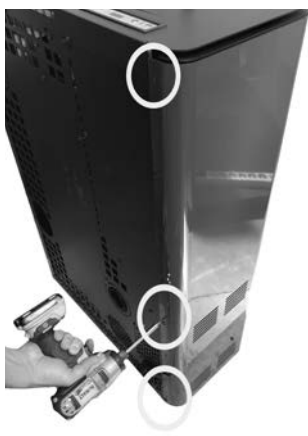
Fig. 48 - Remoção de parafusos 3
