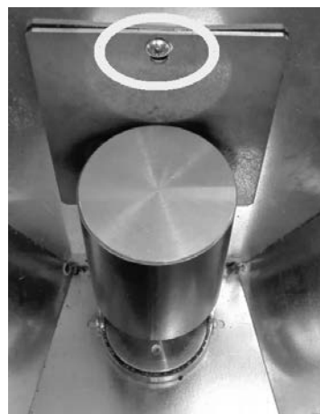
Fig. 74 - Remoção do parafuso
