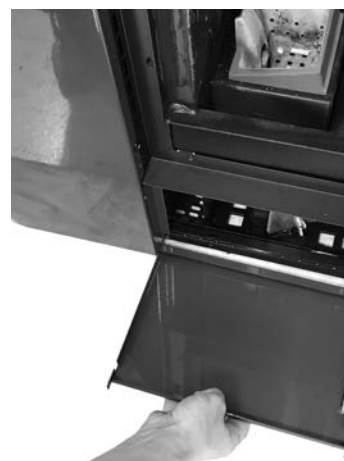
Fig. 46 - Remoção dos painéis dianteiros
