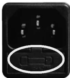
Fig. 72 - Deurtje met te verwijderen zekeringen
