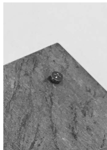
Fig. 31 - De schroef moet uitsteken
