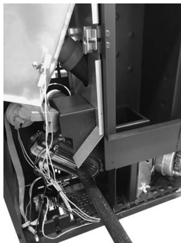
Fig. 69 - Reiniging omgevingsventilator
