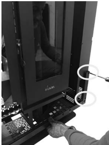
Fig. 35 - Bevestiging onderste beugel
