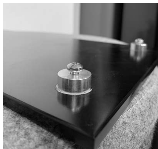
Fig. 38 - De schroef moet uitsteken
