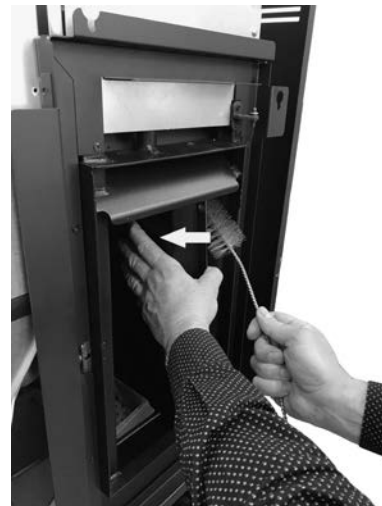
Fig. 68 - Reinig met pijpenwiser
