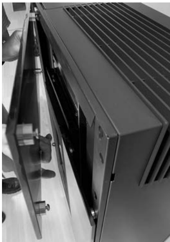
Fig. 39 - Koppel de glas vast
