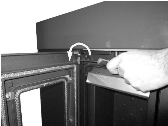
Fig. 20 - Verwijdering van de schroeven
