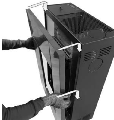
Fig. 26 - Bevestiging lijst op de kachel
