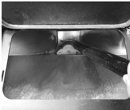
Fig. 35 - Reiniging van de voorraadbak en transportschroef
