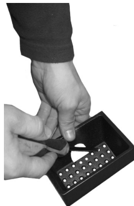
Fig. 32 - Reiniging vuurpot
