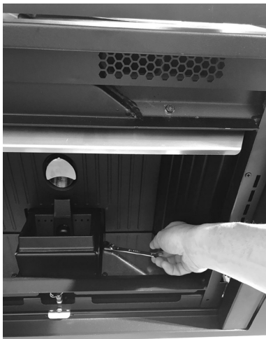
Fig. 36 - Verwijdering bodemplaatjes
