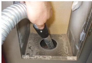
Fig. 38 - Reinigung Fach Brennschale
