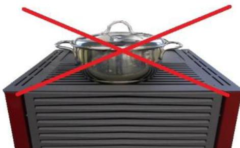
Fig. 24 - Die Lüftungsschlitze nicht verdecken
