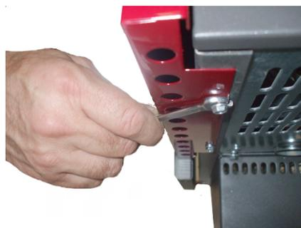
**Fig. 20 - Befestigung der Platten**
