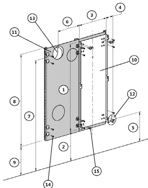
Fig. 17 - Befestigung an einer brennbaren Wand
