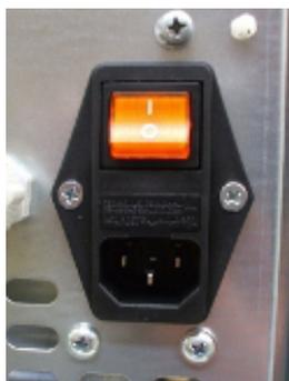
**Fig. 23 - Elektrische Steckdose mit Hauptschalter**
