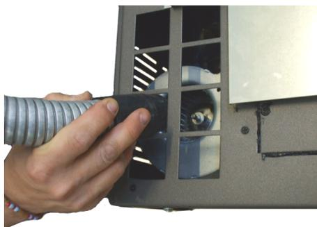
Fig. 49 - Reinigung Raumventilator
