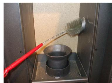
Fig. 39 - Reinigung mit Flaschenbürste
