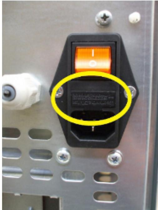
**Fig. 50 - Abdeckklappe mit Sicherungen, die ausgewechselt werden müssen**
