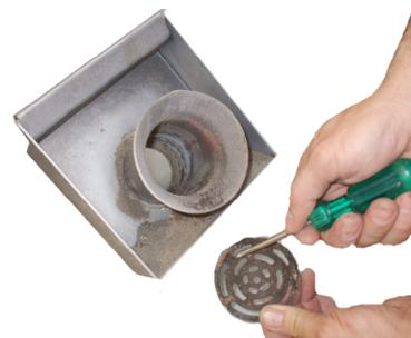
Fig. 36 - Reinigung Brennschale
