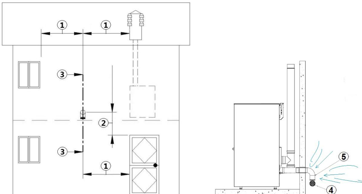
Fig. 7 - Öffnung für Verbrennungsluft für die Installation
