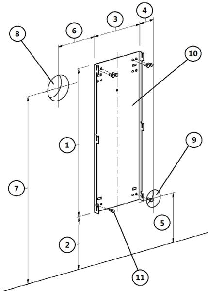
Fig. 16 - Befestigung an einer nicht brennbaren Wand
