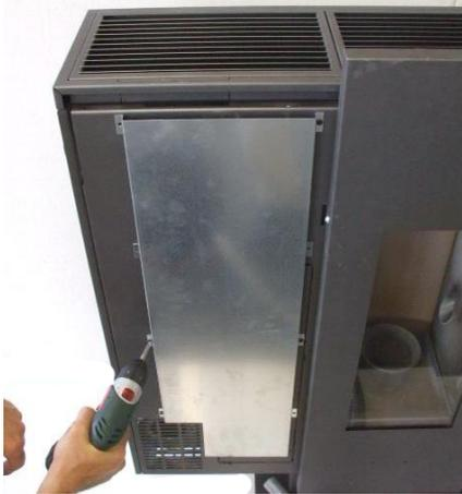
Fig. 41 - Das Wärmeschildpaneel entfernen
