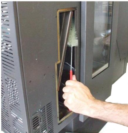
Fig. 43 - Reinigung mit Flaschenbürste
