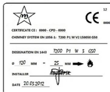
Fig. 3 - Beispiel für Typenschild
