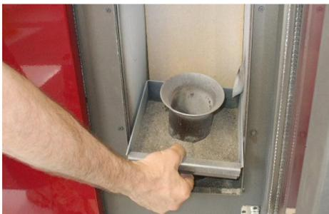
Fig. 35 - Brennschale entnehmen
