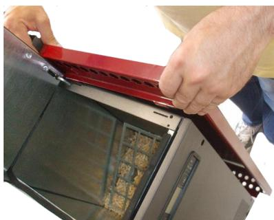
**Fig. 19 - Einfügen der Platten**
