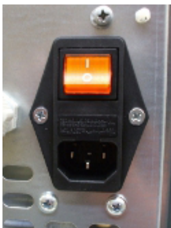
Fig. 29 - Elektrisch stopcontact met hoofdschakelaar
