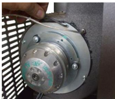
Fig. 50 - Fume fan cleaning: phase 1
