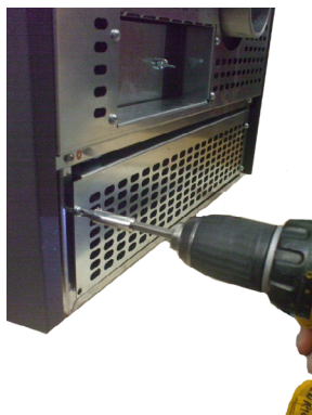
Fig. 55 - Verwijdering achterste rooster
