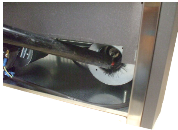
Fig. 56 - Room fan cleaning
