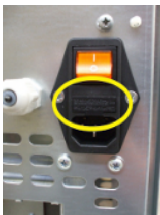
Fig. 62 - Deurtje met te verwijderen zekeringen
