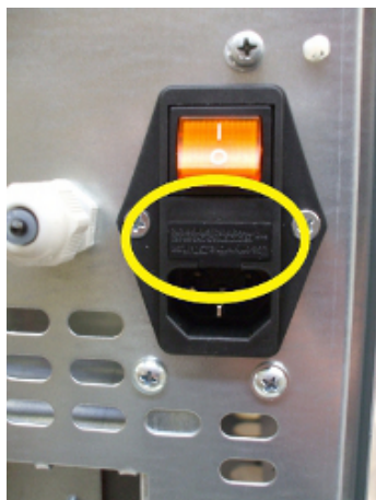
Fig. 63 - Abdeckklappe mit Sicherungen, die ausgewechselt werden müssen
