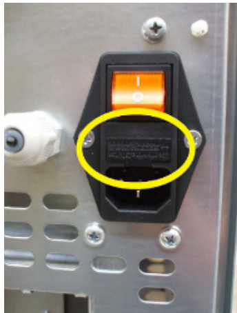
Fig. 63 - Deurtje met te verwijderen zekeringen
