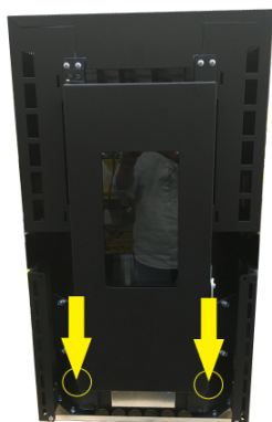
Fig. 19 - Verwijdering van de schroeven
