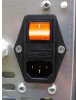
Fig. 26 - Elektrisch stopcontact met hoofdschakelaar
