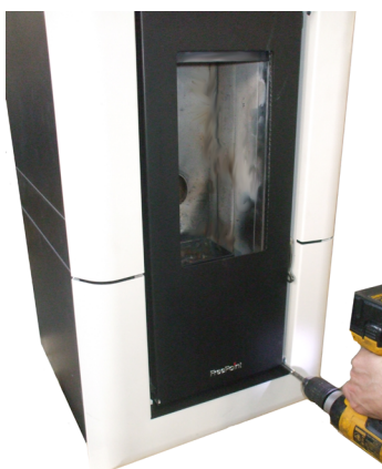
Fig. 54 - Verwijdering onderste schroeven
