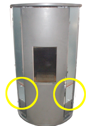
Fig. 50 - Doorgangen van de rookgassen
