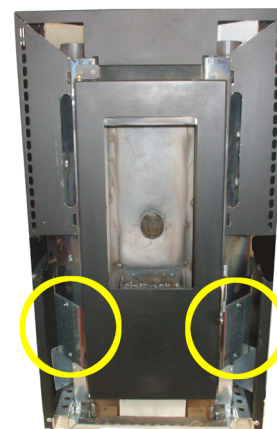
Fig. 56 - Doorgangen van de rookgassen
