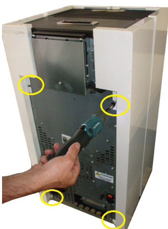
Fig. 18 - Retirer les vis
