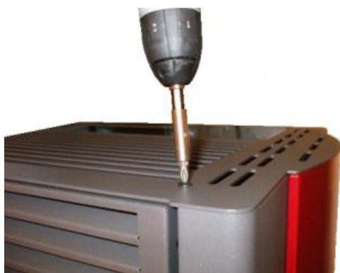
Fig. 13 - Rimozione viti superiori
