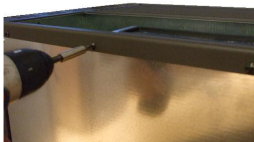
Fig. 14 - Rimozione viti sul retro
