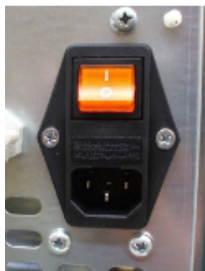
Fig. 24 - Prise électrique avec interrupteur général
