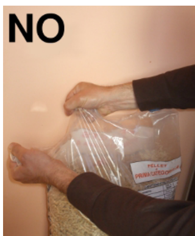
Fig. 28 - Apertura errata del sacco di pellet
