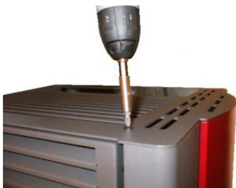
Fig. 13 - Levée les vis superieurs
