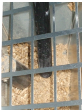
Fig. 36 - Nettoyage réservoir et vis sans fin
