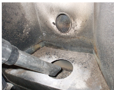
Fig. 33 - Pulizia vano braciere
