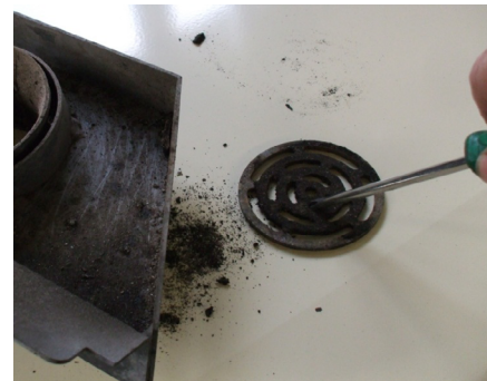
Fig. 32 - Nettoyage du brasero
