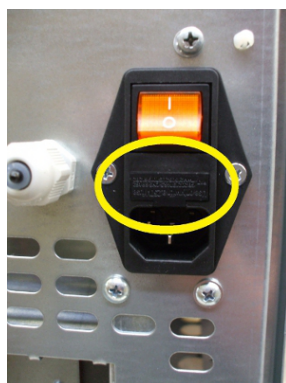
Fig. 48 - Sportellino con i fusibili da rimuovere
