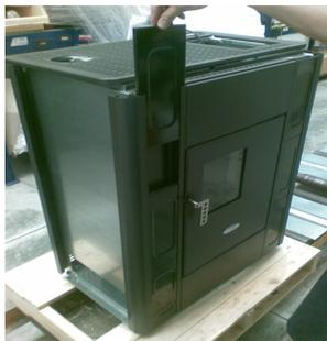
D) Replacer le couvercle au centre au poêle, fixer les 4 vis supérieures et les 3 vis postérieures, enlevées auparavant.
