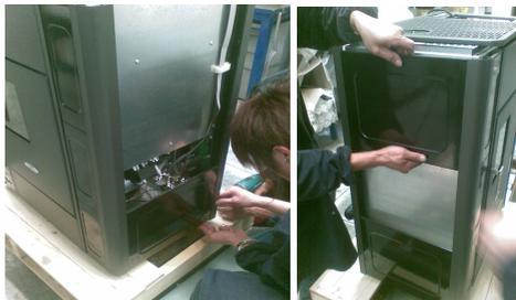
C) Déplacer le couvercle en arrière et insérer du haut les faïences frontales sur les guides prévues à cet effet jusqu'au fond. L'insertion sera un multiple de 3 pièces par côté
