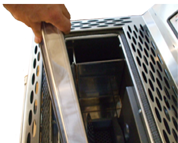
Fig. 20 - Verwijdering van de kookplaat
