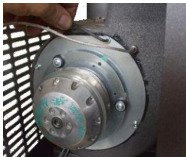
Fig. 31 - Reiniging rookgassenafzuiger: fase 1
