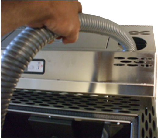
Fig. 30 - Fume conduit cleaning
