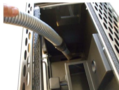
Fig. 22 - Reiniging van de verbrandingskamer
