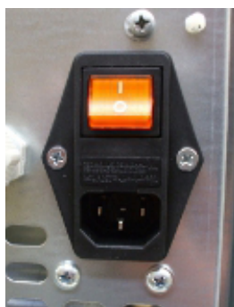
Fig. 15 - Presa elettrica con interruttore generale
