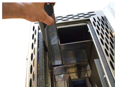
Fig. 22 - Retirez les composants internes
