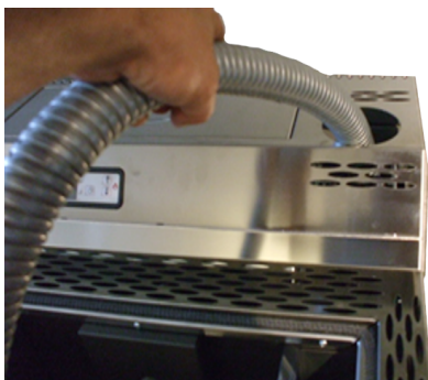
Fig. 31 - Pulizia canale da fumo
