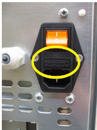
Fig. 35 - Sportellino con i fusibili da rimuovere
