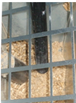
Fig. 27 - Pulizia serbatoio e coclea
