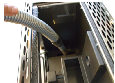
Fig. 23 - Nettoyer la chambre de combustion
