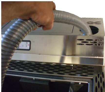
Fig. 31 - Nettoyage du collecteur des fumées
