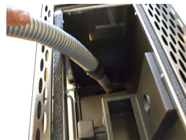
Fig. 23 - Pulizia camera di combustione
