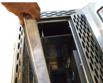
Fig. 21 - Rimozione piano cottura
