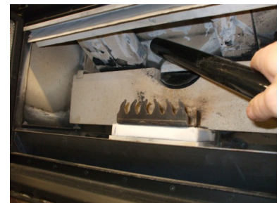
Fig. 46 - Schoonmaak bovenste deel
