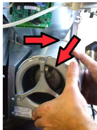
Fig. 62 - Rimozione del ventilatore
