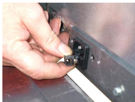
Fig. 64 - Sostituzione del fusibile
