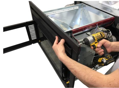
Fig. 38 - Fijación del frente
