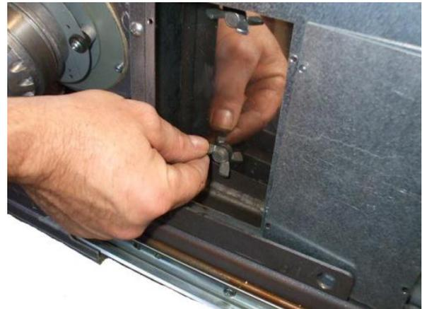
**Fig. 55 - Extracción del 2º panel**
