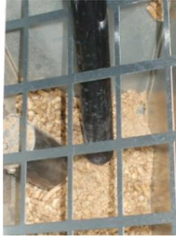
Fig. 48 - Limpieza depósito y coclea
