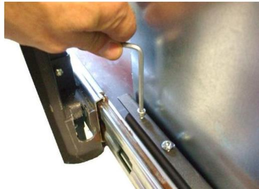
Fig. 16 - Tornillo trasero de fijación del insertable
