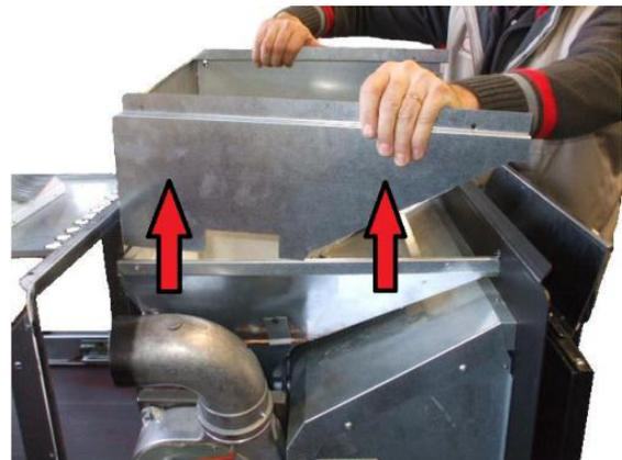
Fig. 61 - Extracción del cárter
