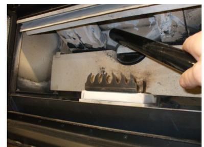
Fig. 47 - Limpieza de la parte superior
