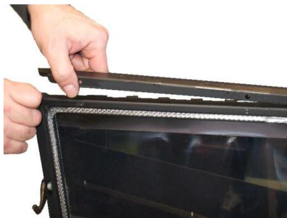
Fig. 57 - Extracción de los perfiles de la puerta
