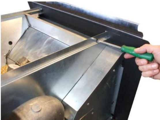
Fig. 60 - Desatornille los tornillos de fijación del cárter
