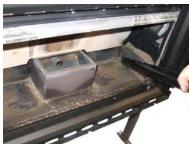
Fig. 46 - Limpieza alojamiento cajón de cenizas
