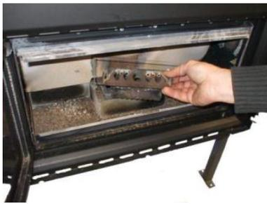
Fig. 40 - Extracción del brasero
