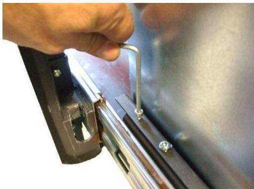
Fig. 21 - Tornillo trasero de fijación del insertable
