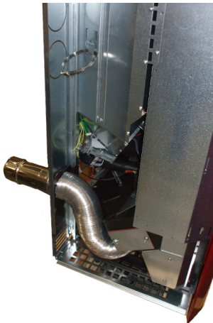
Fig. 47 - Πίσω θέση σωλήνα
