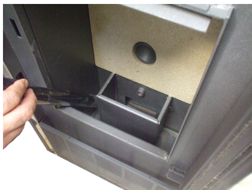
Fig. 58 - Καθαρισμός εσωτερικού μέρους δοχείου καύσεως
