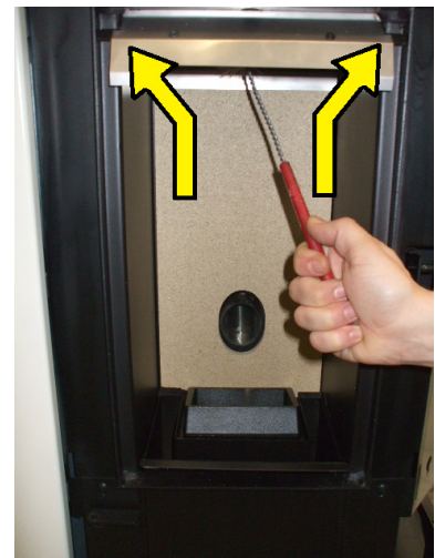
Fig. 78 - Καθαρισμός καναλιού καυσαερίων
