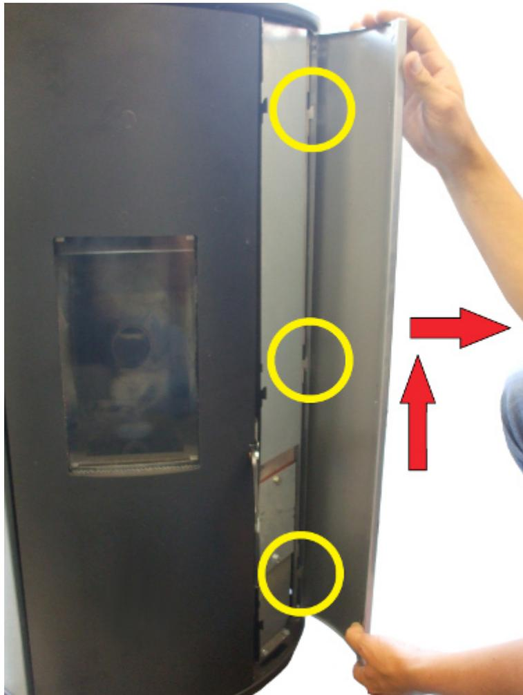
Fig. 67 - Sfera<sup>3</sup> / Sfera<sup>3</sup> Plus: desenganche los paneles laterales.
