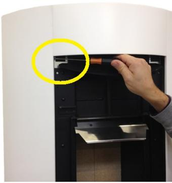
Fig. 74 - Aftoje el tornillo superior
