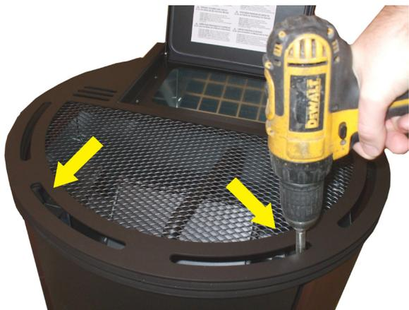
Fig. 68 - Extracción de los tornillos de la tapa 1
