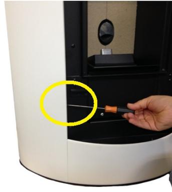
Fig. 75 - Aftoje el tornillo inferior
