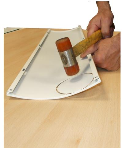
Fig. 31 - Abrir el orificio (modelo Sfera<sup>3</sup> Plus)
