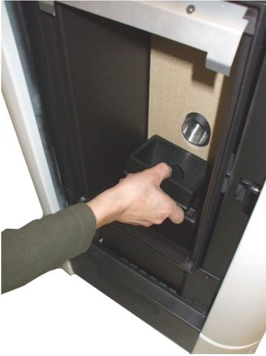
Fig. 56 - Extracción del brasero
