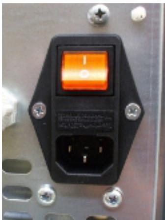
Fig. 44 - Toma de corriente con interruptor general
