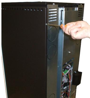
Fig. 63 - Extracción tornillo trasero
