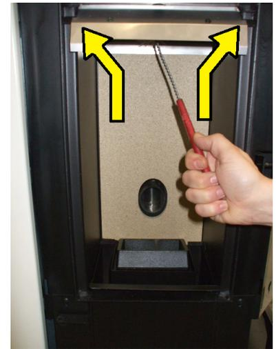
Fig. 79 - Limpie los dos conductos
