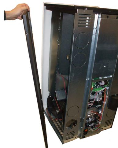
Fig. 64 - Desmontaje de la pared lateral
