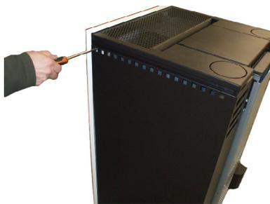
Fig. 62 - Extracción tornillo superior
