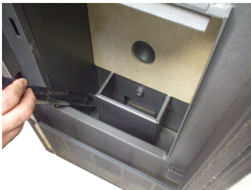
Fig. 58 - Reiniging ruimte vuurpot
