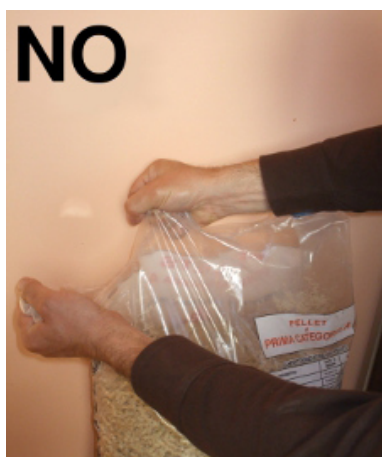
Fig. 52 - Slechte opening de pelletszak
