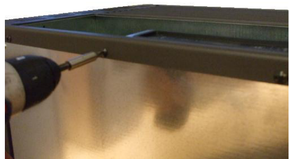
Fig. 15 - Verwijdering schroeven op de achterkant
