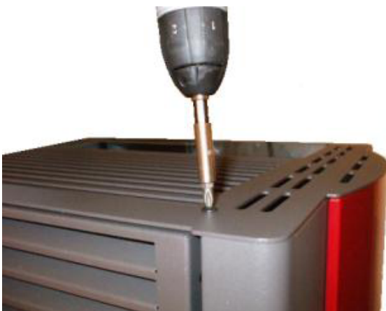
Fig. 14 - Verwijdering bovenste schroeven
