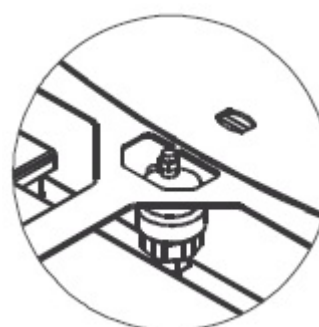
Fig. 23 - Válvula de escape sob o top
