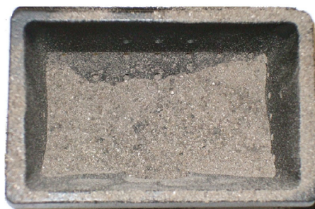
Fig. 38 - Voorbeeld van een vuile vuurpot
