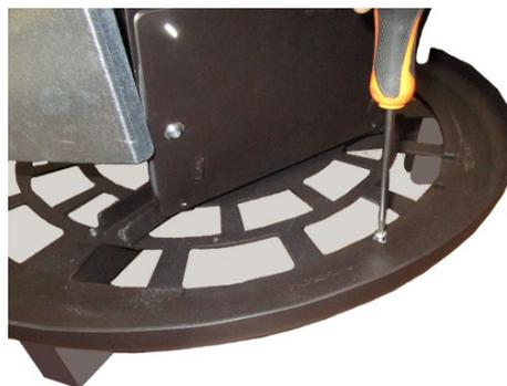
Fig. 41 - Fixation des vis
