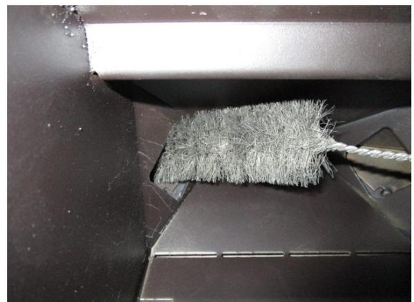
**Fig. 105 - Nettoyage avec un goupillon 4**
