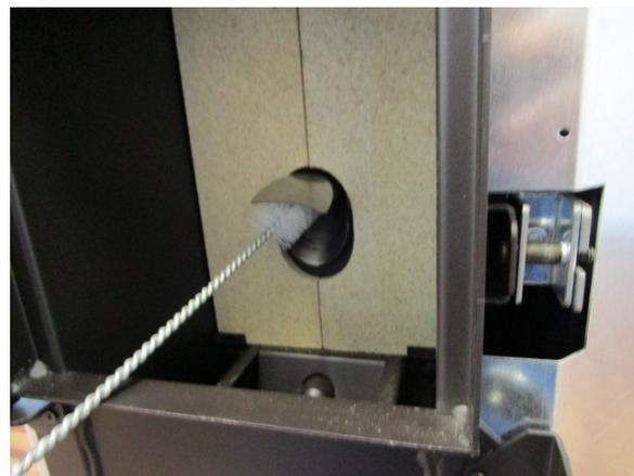
Fig. 92 - Nettoyage avec nettoie-pipes
