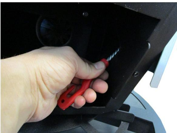
**Fig. 104 - Nettoyage avec un goupillon 3**
