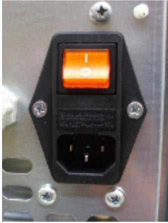
Fig. 69 - Prise électrique avec interrupteur général
