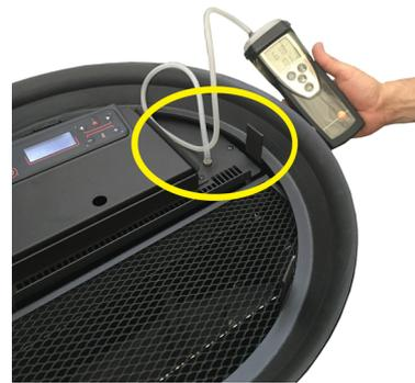
Fig. 71 - Connexion du pressostat numérique
