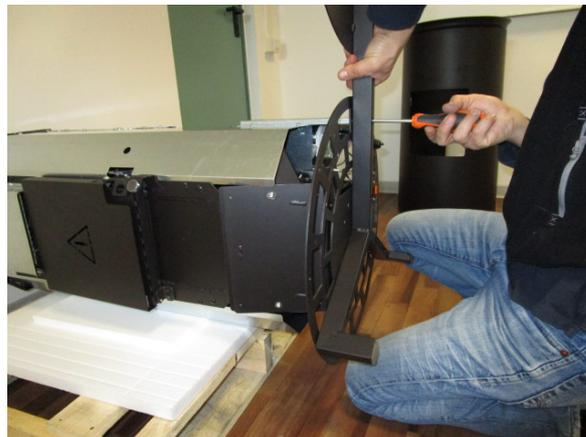
Fig. 51 - Fixer le piédestal du banc
