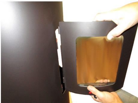
**Fig. 27 - Rimozione porta**
