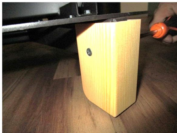
Fig. 44 - Fissaggio piedini
