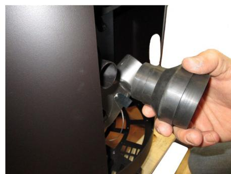
Fig. 26 - Rimozione adattatore
