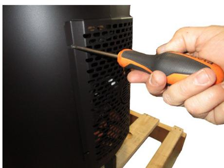
Fig. 25 - Rimozione carter
