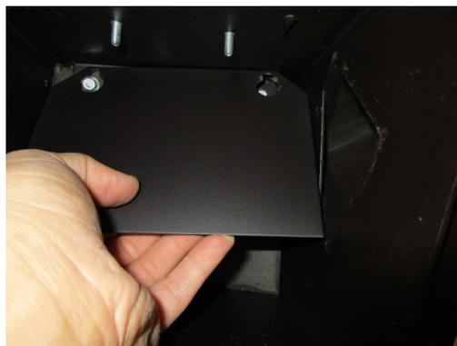
Fig. 97 - Rimozione deviatore fumi
