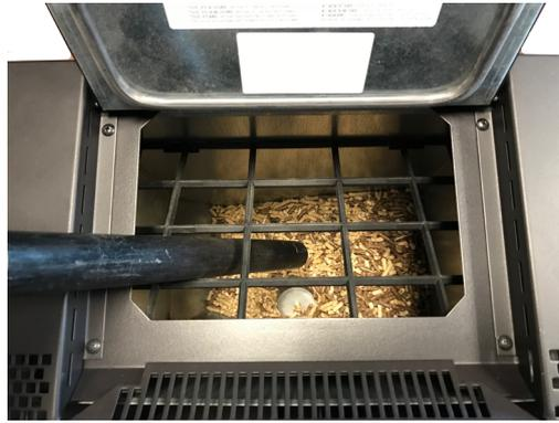
Fig. 91 - Pulizia serbatoio e coclea
