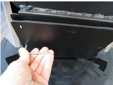
Fig. 93 - Rimozione viti
