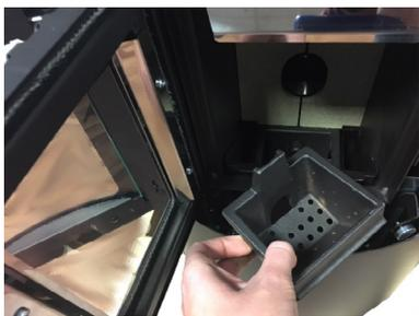
Fig. 86 - Rimozione braciere
