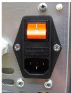
Fig. 66 - Presa elettrica con interruttore generale
