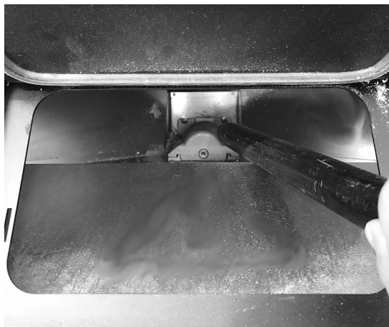
Fig. 24 - Limpeza do reservatório e da rosca sem fim
