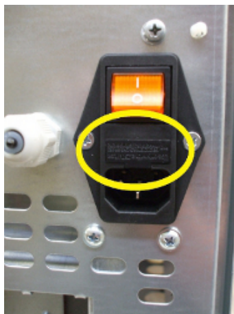
Fig. 45 - Abdeckklappe mit Sicherungen, die ausgewechselt werden müssen
